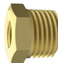
170600 Amarelo Rosca Externa: NPT 1/2" BUCHA DE REDUÇÃO Rosca Interna: NPT 1/8"
