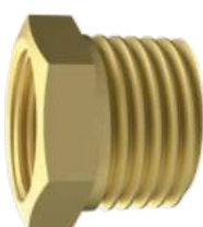
170602 Amarelo Rosca Externa: NPT 1/2" BUCHA DE REDUÇÃO Rosca Interna: NPT 3/8"
