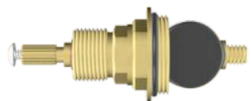
039152 Acabamento: Fabrimar RIO 3/4 Bitola: 3/4 Estria: Fabrimar Rosca: N° 118 Cunha: N° 70
